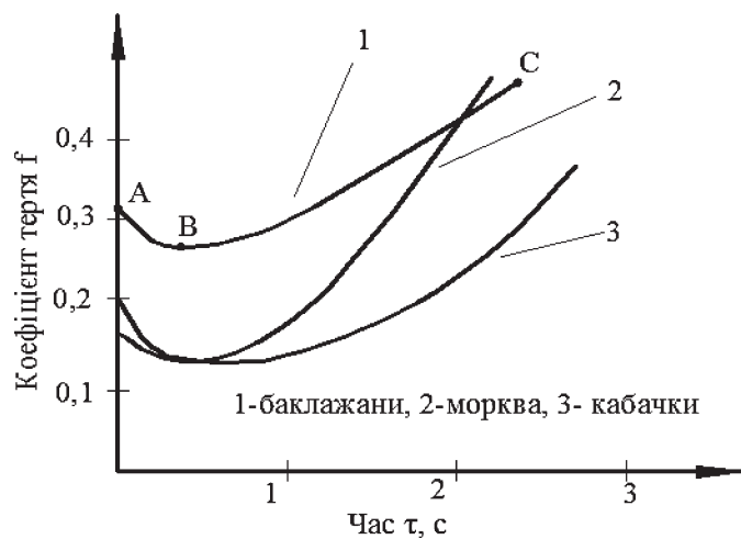
Рисунок 1 — Криві зміни коефіцієнту тертя в часі при постійній швидкості ковзання:
